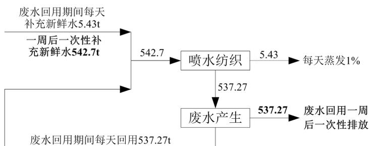
图 3-2 本项目水平衡图
