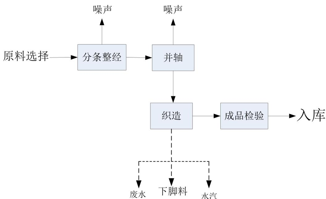
图 3-3 喷水织造工艺流程图
